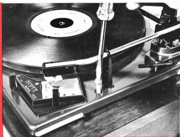
FISSAGGIO DEL GIRADISCHI. Questo giradischi automatico ha due viti per il trasporto, che gli impediscono di muoversi, evitando possibili danni al motore. Le viti si ruotano in senso antiorario per fissare il giradischi alla base ed in senso orario per lasciarlo libero sulle sospensioni. Il giradischi qui illustrato è il Garrard 2025TC.
